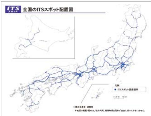
と同じ通信方式のDSRC（スポット通信）を採用し、道路に設置された無線機から自動車に提供します。ビーコン方式のVICSに比べて提供される情報は遥かに高速・大容量で、VICSでは最大200kmでしたが、最大1000kmの道路区間ごとの所要時間データが提供されます。
