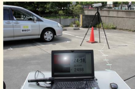
ナンバー自動読取装置。カメラで撮影したナンバーから車検切れ車両を捕捉し、モニター上に情報を表示する
