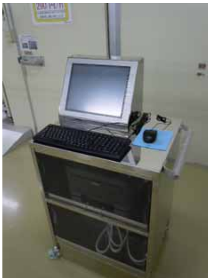
ワゴン型現場利用端末(無線LAN機能) キャスター型で防塵・防滴機能に優れる
