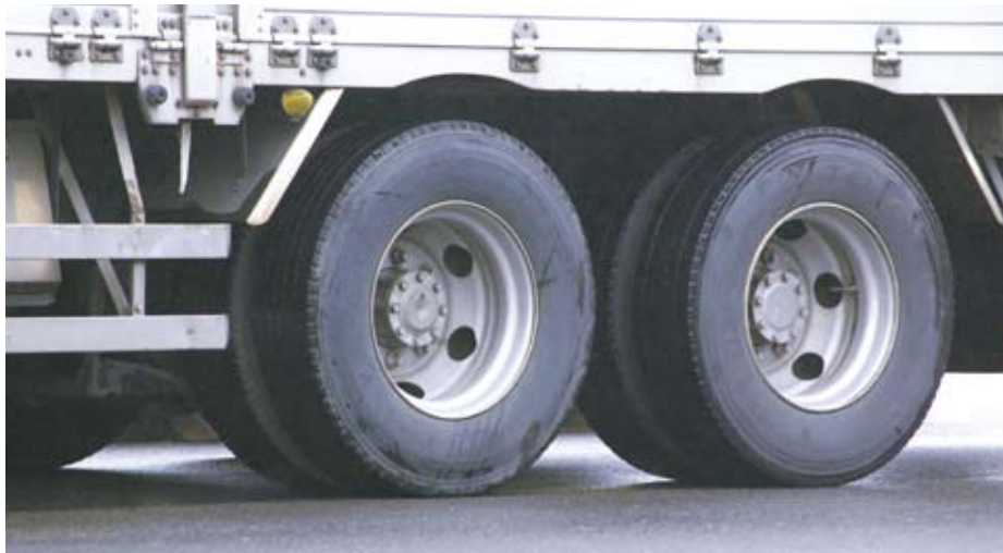
大型トラックの後輪タイヤをよく見ると、リトレッドタイヤがよく使われている。単価が高いタイヤ再利用は経済的で、環境にもやさしい
