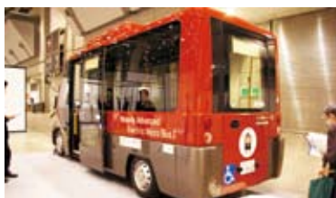
非接触充電で走行する小型電気バス。電池を効率の良いリチウムイオンに変えた実験が今年始まる
