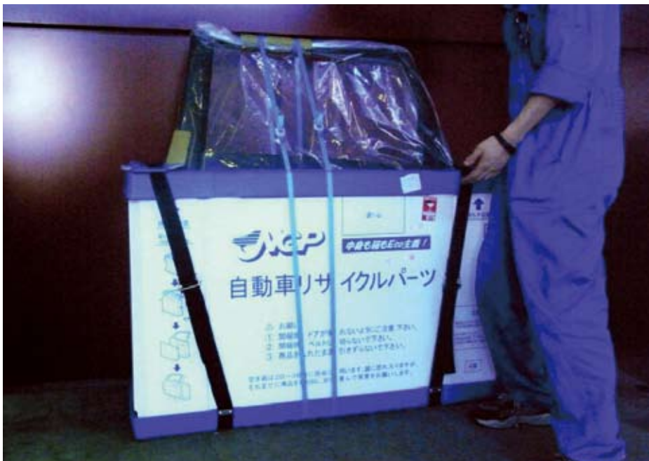
ワンサイズの容器でも工夫すれば大きなサイズも梱包可能、安定もしている
