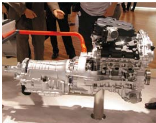
新型「フーガ」に車種追加で搭載されるハイブリッドユニット
