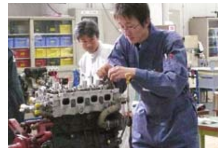
エンジンを分解しながら構造と不具合の知識を深める
