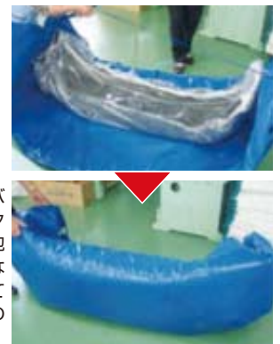
開発途中のバンパー用リターナブル梱包材、持ち手なども工夫して使いやすさの改善を検討
