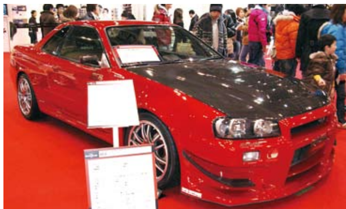
ボンネットをカーボン樹脂に変えたチューニングカー。カスタマイズの世界です にカーボン樹脂の利用は当たり前になっている(東京オートサロン2010で)
