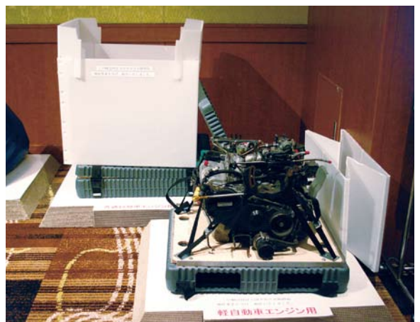
試作途中の軽エンジン用のリターナブル梱包材
