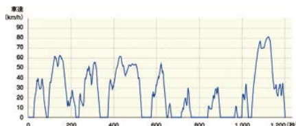
燃費測定のハードルを高くしたJC08モードのパターン
