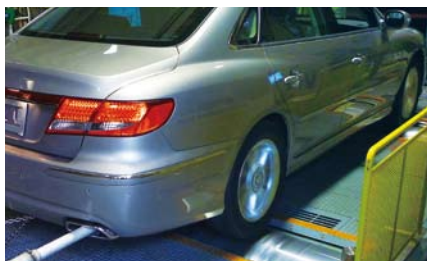
シャシーダイナモ上で計測する自動車の排ガス試験。各国・地域でばらばらだったその走行パターンが同じになるようとしている
