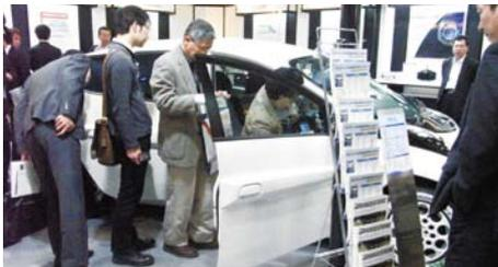
SIM-Driveは先行開発車事業のプレゼンとともに先行開発車第1号の「SIM-LEI」(=写真)、同2号の「SIM-WIL」を展示。いずれもインホイールモーターによるアウトローター式ダイレクトドライブで駆動、第1号は24.9kWhのリチウムイオン電池を搭載し、一充電268kmを走行する。
