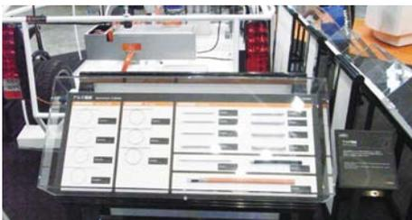
矢崎総業のブースは電子部品、電装品をネットワークする車載電線を展示。こちらも軽量化が求められており、約30%の軽量化につながるアルミ電線、太さで通常銅線のおよそ3分の1、0.13mmという高強度極細電線を並べた。部品の進化、素材の変化を感じることができるのもテクノロジー展の魅力。
