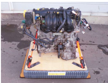
エンジンを搭載ベルトで固定
