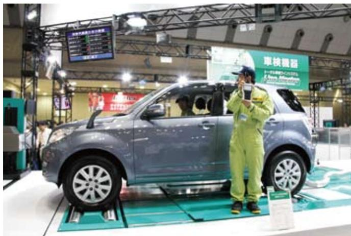
安全自動車は車検システムとスキャンツールを連携させた次世代高度 OBD 検査を実演
