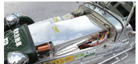
「狭いエンジンルームにバランス良く搭載するのに苦労した」（中里社長）というリチウムイオンバッテリー。車体前後左右に装着されるパイプはバッテリー保護用のバンパー
