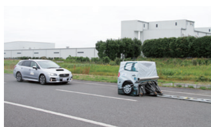
公開デモ試験で実施された、けん引走行するターゲットへの追突回避の様子。車両は40点満点を獲得したスバル・レヴォーグ
