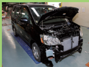
フロント部修理で入庫中のトヨタノア。対物保険の限度額を超過したためボンネット及び右フロントフェンダーにNGPリサイクル部品を使用
