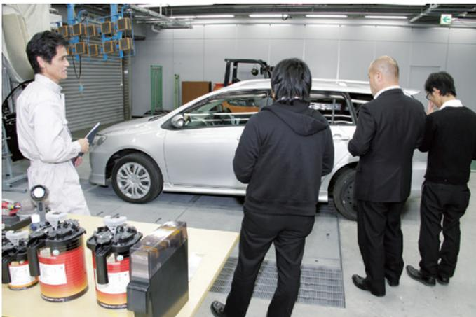
一部工程を簡略化して修理されたカラーフィールダーの左フロントフェンダー及びフロントドアパネルを確認。注意深く見れば色の違いが分かるものの、一般カーオーナーの大半には判別できないレベルに仕上げられている
