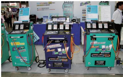
2種類のコンプレッサーオイルのみならずHFO-1234yfにも対応したエアコンガスチャージャー(中央)
