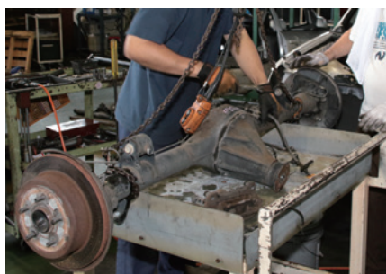
クレーンを使用し(株)マルトシ青木の生産スタッフからアドバイスを受けながらリヤホーシングを分解
