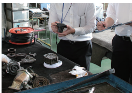
分解したエアコンコンプレッサーを部品ごとに写真撮影し重量を計測
