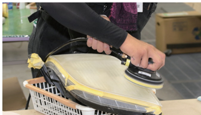
徐々にサンドペーパーの番手を上げながらダブルアクションサンダーで黄ばんだ旧コーティング塗膜を除去
