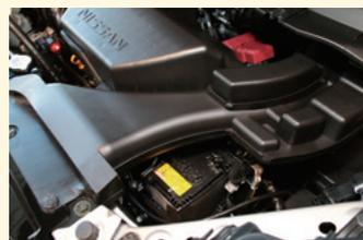
S-ハイブリッド用の12Vバッテリー2基は吸気ダクト及びエアクリナーボックスの下に搭載される
