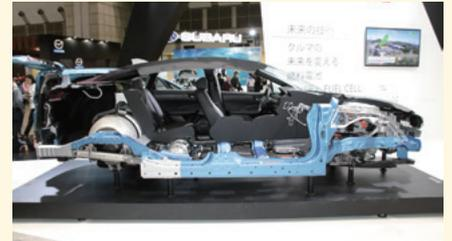
ホンダブースに展示されたクラリティフューエルセルのカットボディ(上)と同車のボディ構造。超高張力鋼板のみならずアルミや樹脂も多用されている
