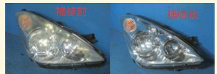
黄変しハウジングが折れたヘッドランプ(左)も修理後(右)は新品同様に
