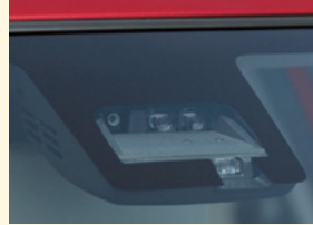
フロントガラス上部に装着されるDSBSの単眼カメラ+レーザーレーダー一体型センサー
