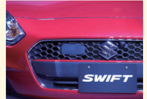
ACC用のミリ波レーダーはフロントグリル右上(写真中央)に装着される
