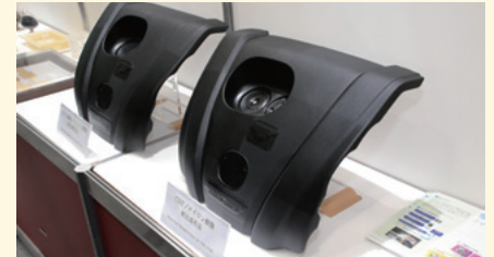
NCVプロジェクトはGFRP + ナイロン樹脂の従来品（奥）に対し約10%軽量化したCNF + ナイロン樹脂製のエンジンヘッドカバーを公開
