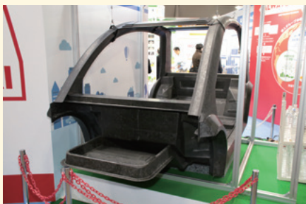
約1分で成型可能な熱可塑性CFRPを全面的に採用し、ボディ重量を47kgにまで軽量化した、帝人のコンセプトカー「セリーボ」
