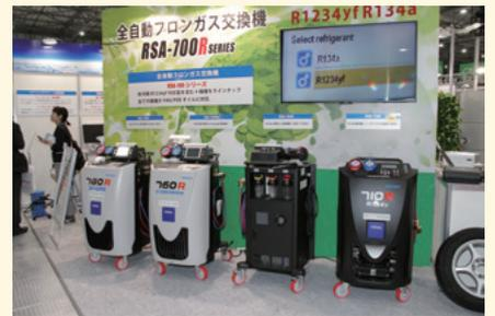
オゾン層保護法の改正を受けて、今後国産車でも採用車種の増加が見込まれる新冷媒に対応した冷媒回収再生装置に注目が集まった
