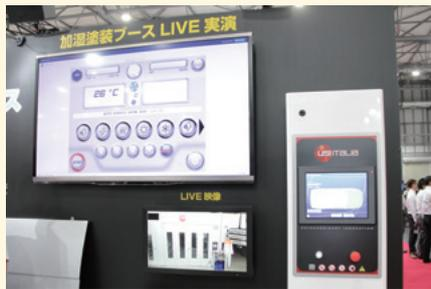
塗装ブースの状態をインターネット経由でメーカー側から確認できるシステム。トラブルが発生した際の原因調査などに活用が可能で、塗装ブースの故障による生産性の低下を防止・削減する効果が期待できる
