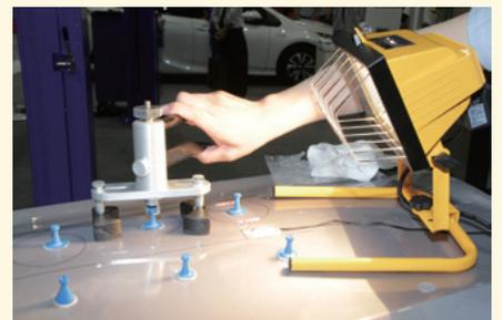
アルミ合金に対応したスタッド溶接機や、接着剤を用いた引き出し钣金システムなど、アルミパネル修復への提案もなされた
