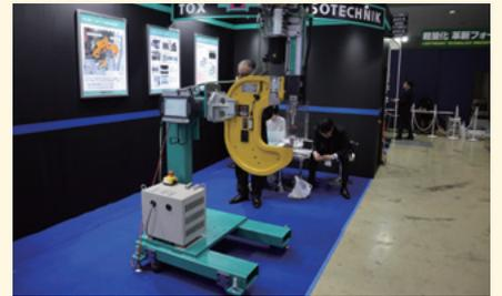
トックス プレンテックは、輸入車の新車ラインなどで採用されている、アルミと鋼板の接合技術を紹介。特殊なポンチとダイを用いて2枚のパネルを加圧することで、リベットや副資材、熱などを用いることなく、異種金属を接合することができる
