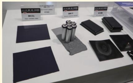
三菱マテリアルは、耐熱樹脂や伝熱パテ、耐火ゴム、薄型温度センサーなど、リチウムイオンバッテリーパックに必要とされる各種素材・技術を紹介した
