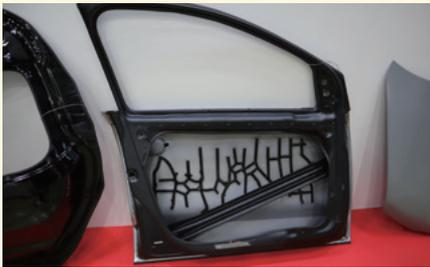
JFEスチールは、鋼板を樹脂(GFRPやCFRP)で補強することによるドアパネルの軽量化を提案。0.5mmの鋼板の裏側に、トポロジー最適化技術によって設計された樹脂製補強部品を接着したドアパネルを展示した
