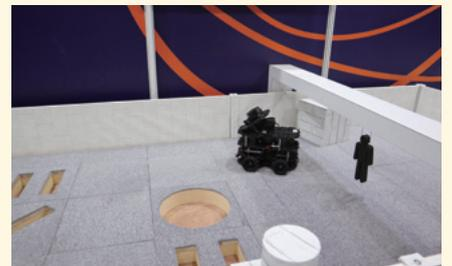
NECは、2台のLiDARでリアルタイムに周辺環境を認識し、穴や障害物を回避する自律走行ロボットの走行デモを披露
