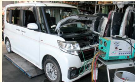
自動車リサイクル法に基づき、エアバッグ、フロンガス、油脂類等を適切に処理します。エアバッグ類の装備状況、使用されている冷媒などの情報は、自動車リサイクル促進センターが運用するシステムで1台ごとに確認し、法令遵守を徹底します。
