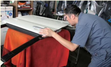
NGPは商品化登録基準マニュアルを作成し、部品ごとに検査登録のルールを定めています。商品化登録基準のもと、傷や凹み、ひずみなどがなければ、厳しくチェックします。
