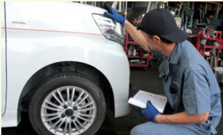
車両引き取り後、まず車両の状態を確認します。目視点検のほか、工場敷地内での走行テストやスキャンツールによるエラーコード等のチェックをします。その点検結果に応じて、リサイクル部品として再利用する部位、分別し資源等とする部位を選別し、それら情報等を記載した作業指示書を作成します。
