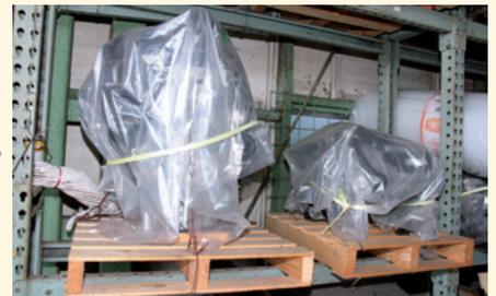
NGPシステムに登録後、商品が劣化しないように保管します。NGPではリサイクルエンジンの品質を維持するため、屋内保管必須（屋根のみの倉庫は不可）、土間置き禁止などの保管基準を設けています。
