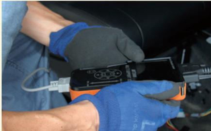
工場敷地内での走行テストやスキャンツールによるエラーコードのチェックなどの検査を行い、エンジンの再利用が可能かどうかを確認します。
