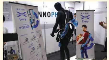
イノフィスは圧縮空気を利用した人工筋肉で、腰への負担軽減や力作業の補助をするアシストスーツをPR
