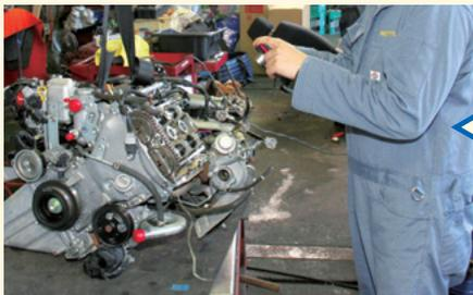
外観写真だけでなく、シリンダーヘッドカバーを取り外し、シリンダーヘッドの状態も撮影します。また、ターボ付きエンジンの場合は、タービンの状態も確認します。
