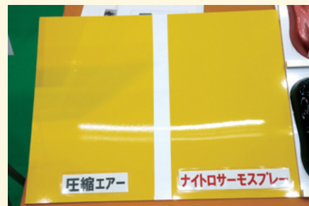
日本ジェット・オンは、窒素を利用したイタリア製の塗装システム「ナイトロサーモスプレー・システム」を紹介。塗料の使用量削減につながるほか、塗りムラやオーバースプレーを抑制して仕上がりも向上させる
