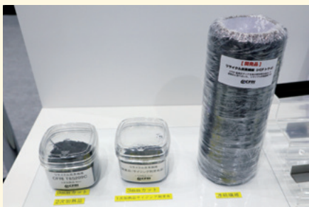
新エネルギー・産業技術総合開発機構（NEDO）は、航空機を製造する際に発生した端材を利用した炭素繊維を出品。車の軽量化を図るため、エンジン部品などに使用することを提案した
