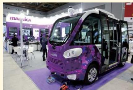
マクニカは、フランス・NAVYA社製自動運転バスを展示。障害物検出用のLiDAR、走行距離を算出するオドメトリ、車両位置を特定するGNSS、自車周囲の安全を確認するカメラ、オートライドやオートワイパーを作動させる感知センサーなど各種装置を搭載することで、レベル4の自動運転に対応
