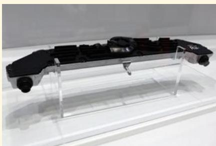
ザイリンクスは、SUBARU新型レヴォーグが搭載する新世代アイサイトに採用されたプロセッサー技術を紹介。高い処理能力により、ステレオカメラからの画像を高速で3Dポイントクラウド化する。また、量産開始後もOTA（Over the Air）で性能の向上が可能となる
