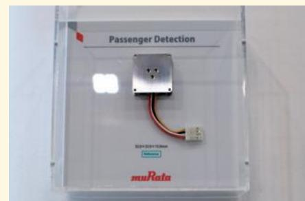
村田製作所は、バイタル信号から人と物、大人と子どもを区別する荷重センサー（写真）や、WiFiの電波で車室内の状況を監視するシステムなど、Euro NCAPに2022年から試験項目として加わる幼児置き去り検知機能に対応する技術を紹介
