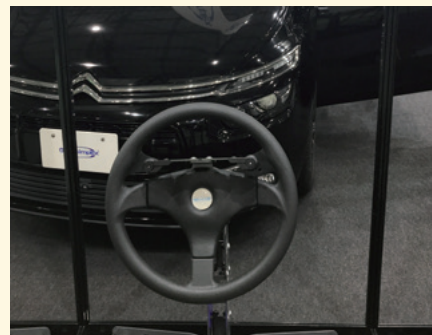
Guidosimplex Japanは、ステアリングに装着してアクセル操作やステアリングスイッチのコントロールができる「906GV プッシュタイプエレクトロニックアクセルリング」を紹介
