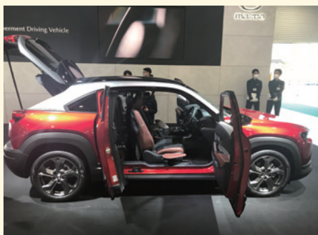
マツダは運転補助装置と乗降用補助シートを装備したMX-30（写真左）を参考出品。アクセルリングとハンドブレーキを装備し、手動で発進と加減速を制御する。また、すでに市販されているロードスター（写真右）は、アクセルとブレーキ操作を左手で行うためのコントロールグリップと、旋回を補助するステアリングノブを備える
