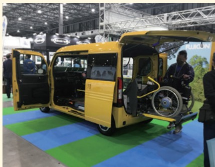
フジオートは、荷室に昇降リフトを備えたN-BOXを出品。このほか電動で車いすを収納するアームリフトや、シートへの移乗を補助するトランスファーボードといったオリジナル装置もPR
