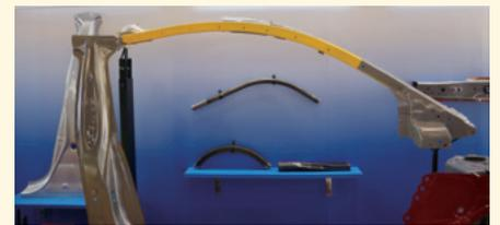
**Eイチワン** ホンダNSXのフロントビラーに採用された、3次元熱間曲げ焼入れの技術を紹介。鋼管を局部的に加熱して曲げ加工し、直後に急冷して焼き入れることで、金型を用いずに複雑な形状の高強度な鋼管の製造が可能となる
