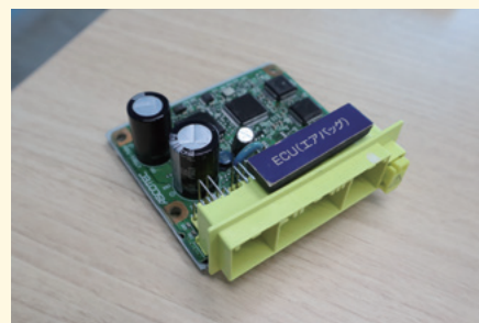
EDRの多くはエアバッグコントロールユニット内に搭載されている
