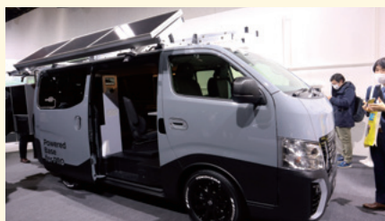
日産自動車 リーフの再生バッテリーを活用したポータブル電源を搭載するキャラバン。ルーフには太陽光パネルも搭載
