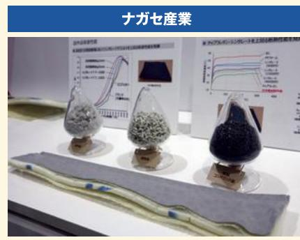
新車製造工程で年間約1,000トンにもなる自動車天井内装の端材を粉碎して作られたフィラー材を出品。粉碎品、造粒品、樹脂コンパウンド品など用途に応じた形体での供給も可能
