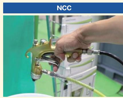
塗着効率が高い特殊なガンを用いることで、大型車の防錆作業などの使用塗料削減に寄与するエアミックスや、塗膜を焼いて炭化させるはく離炉などを紹介
