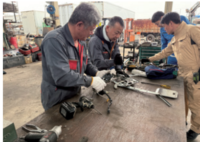
部品を分解し、素材ごとに仕分ける様子
