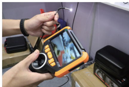
コントローラーでピストンシリンダー内部を検査できるカメラシステム
