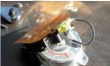
取り外したインフレーターは、メーカーの指定したケースに梱包して指定の引き取り場所に運搬する。
