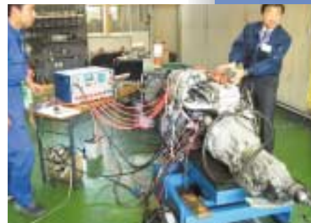
E/G始動中に燃料噴射量、点火時期も調整可能
