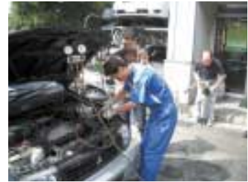
リサイクル法の中で特定3品目にも指定されているフロン類の回収作業風景
