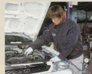
使用済みフロン回収作業
