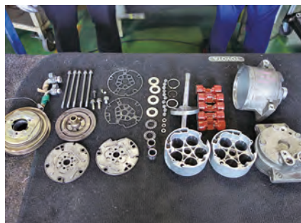
●部品は出来る限り細かく分解し素材と重量を調査 (写真はACコンプレッサー)
